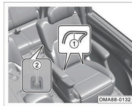
El punto de fijación inferior ① del asiento de la segunda fila está oculto en el hueco entre el respaldo y el cojín del asiento; el punto de fijación superior ② está en la parte trasera del respaldo del asiento.
