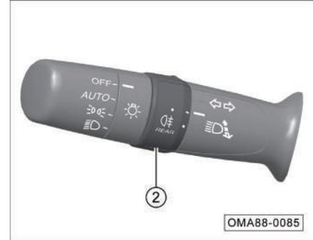
Cuando la alimentación del vehículo está en la posición "ON", y la luz de cruce está encendida, gire el interruptor de la luz antiniebla ② para encender o apagar
