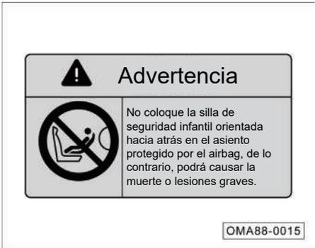
En la parte delantera y trasera del visor derecho hay una señal de advertencia para alertar de los peligros de los airbags frontales para el pasajero de la fila delantera. Lea y siga las instrucciones en las señales.
