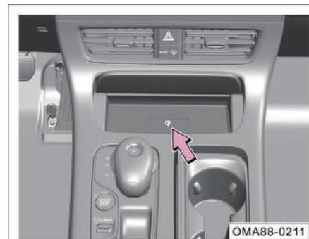
El área efectiva de carga inalámbrica se encuentra en la ranura de almacenamiento frente a la palanca de cambios. Al cargar, alinee la bobina de carga del teléfono móvil con la marca "Qi" para garantizar la carga normal del teléfono móvil.
