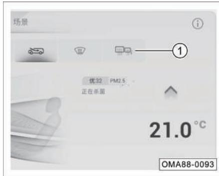
Ingrese a la interfaz principal del control del aire acondicionado frontal a través del sistema de audio y haga clic en el botón programable ① para encenderlo/apagarlo. La luz del botón ② está encendida cuando está encendido.
