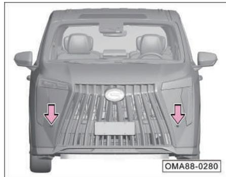
El sensor de radar delantero está montado en el parachoques delantero. Solo hay 2 radares de esquinas delanteras en el parachoques delantero y están ubicados cerca de las esquinas. Solo pueden detectar áreas parciales en las esquinas y el área ciega directamente frente al vehículo es grande.
