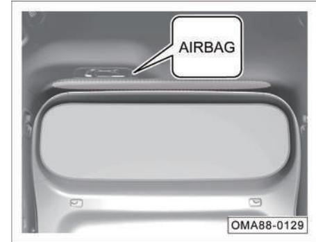
El airbag del parabrisas trasero está instalado en la parte trasera del techo (zona sombreada por la línea de puntos) y "AIRBAG" es el símbolo del airbag.
