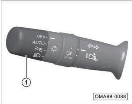
2. Gire el interruptor de luz a la posición ① y en la posición de luz de cruce, el brillo ambiental es bajo y la luz de cruce se enciende automáticamente, y la velocidad del vehículo es superior a 25 km/h, se permite que la función ADB de luz de carretera adaptativa activa, en este momento la luz de carretera entra en el estado de control inteligente, y la luz de carretera adaptativa saldrá automáticamente cuando la velocidad del vehículo sea inferior a 15 km/h.
