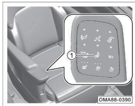
Presione brevemente el botón de restablecimiento ①, las posiciones delantera y trasera y los respaldos y los reposapiernas de los asientos de la segunda fila volverán a sus posiciones originales. Si existe riesgo de pellizco en las piernas durante el proceso de reinicio, puede presionar cualquiera de los botones de ajuste hacia adelante y atrás/botones de ajuste del respaldo/botones de ajuste del reposapiernas del asiento para detener la acción de reinicio del asiento.
