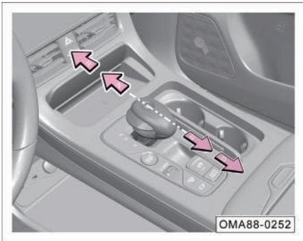
La palanca de cambios tiene las marchas “P, R, N, D”. Cuando la alimentación del vehículo está en la posición “ON”, el panel de instrumentos muestra la información de la marcha correspondiente después de cambiar de marcha.
