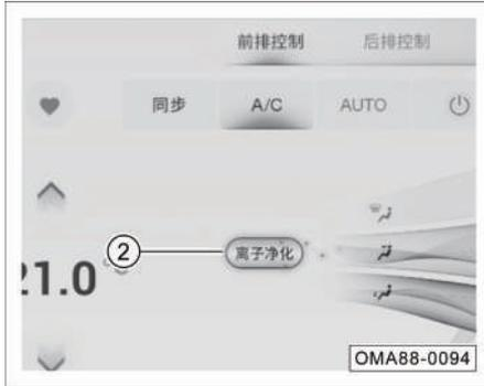
Haga clic en el botón programable “Purificación de iones” ② en la interfaz de control del aire acondicionado del sistema de audio para encender el purificador de aire de plasma. Puede generar plasma, descomponer eficazmente gases nocivos como el formaldehído y el benceno en el vehículo y purificar el aire del vehículo.
