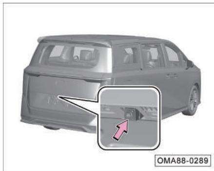
La cámara trasera queda instalada al lado de la luz de matrícula.
