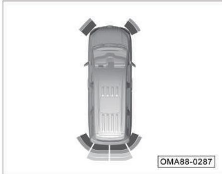
El icono dinámico en el lado izquierdo de la pantalla indica la distancia entre la parte delantera y trasera del vehículo y el obstáculo. En la figura, el color de la barra de radar del vehículo es rojo-naranja-amarillo-verde de adentro hacia afuera. A medida que el obstáculo se acerca más y más al vehículo, la línea de color disminuirá gradualmente de la capa más exterior a la capa interior.
