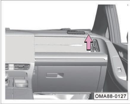
El airbag frontal del pasajero delantero está montado en el interior del panel de instrumentos (zona sombreada con línea discontinua) con el símbolo "AIRBAG".
