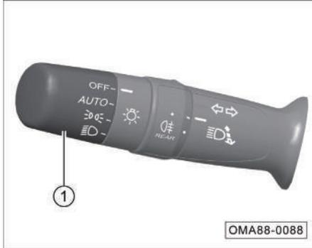
Cuando la alimentación del vehículo está en la posición "ON", al girar el interruptor de la luz ① se puede controlar para encender o apagar AUTO (luz automática), ☀ (luz de posición), ☀☀ (luz de cruce).
