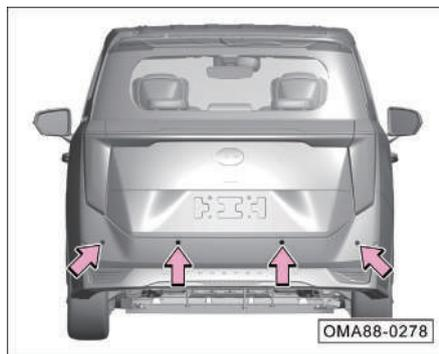
El sensor ultrasónico trasero está montado en el parachoques trasero.
