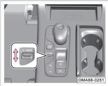
1. Con la alimentación del vehículo en la posición "ON", puede cambiar entre "Modo de ahorro de energía → Modo deportivo → Modo de confort → Modo de ahorro de energía..." moviendo la aleta de selección del modo de conducción (D-MODE) hacia arriba/abajo para recorrer el modo de conducción objetivo.
