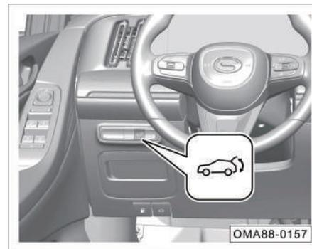
Mantenga presionado el botón del portón trasero en el panel de instrumentos y el portón trasero se abrirá eléctricamente hasta la altura establecida. Durante la apertura eléctrica, presione el botón nuevamente, el portón trasero dejará de abrirse.
