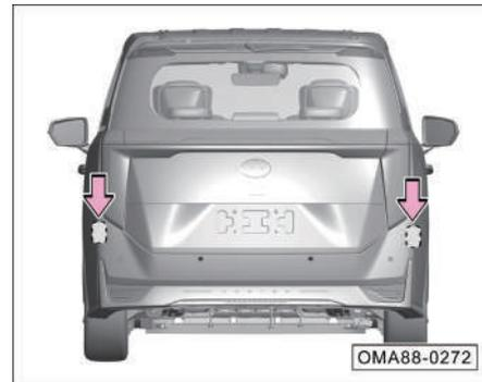
La posición de montaje del sensor de radar en el sistema de monitoreo de punto ciego se muestra en la figura anterior.
